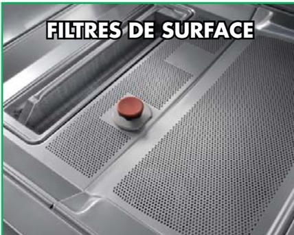
Des filtres en acier inox couvrent toute la surface de chaque cuve. L'aspiration de pompe est également protégée par un filtre de sécurité.
