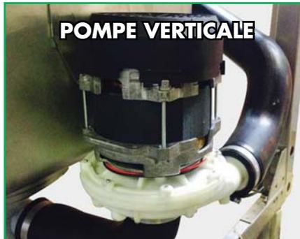
Les pompes surpuissantes, sont toujours adaptées au volume de la cuve. Elles sont autovidangeables et positionnées à l'extérieur.
