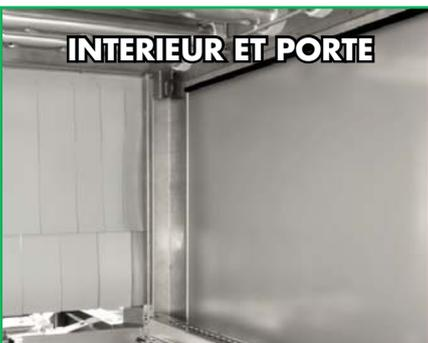
L'enceinte est totalement et facilement accessible, toutes les conduites sont positionnées à l'extérieur. La porte est d'un relevage aisé et les ressorts sont incorporés dans la double paroi.
