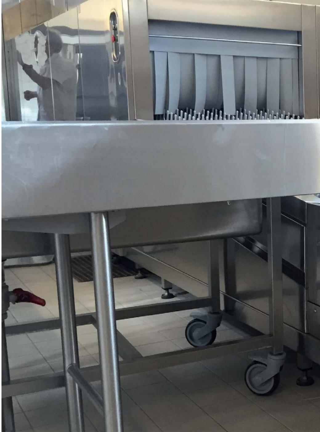
Entrée surbaissée et inclinée pour chargement avec 4 trieurs avec hauteur de travail à 900 mm
