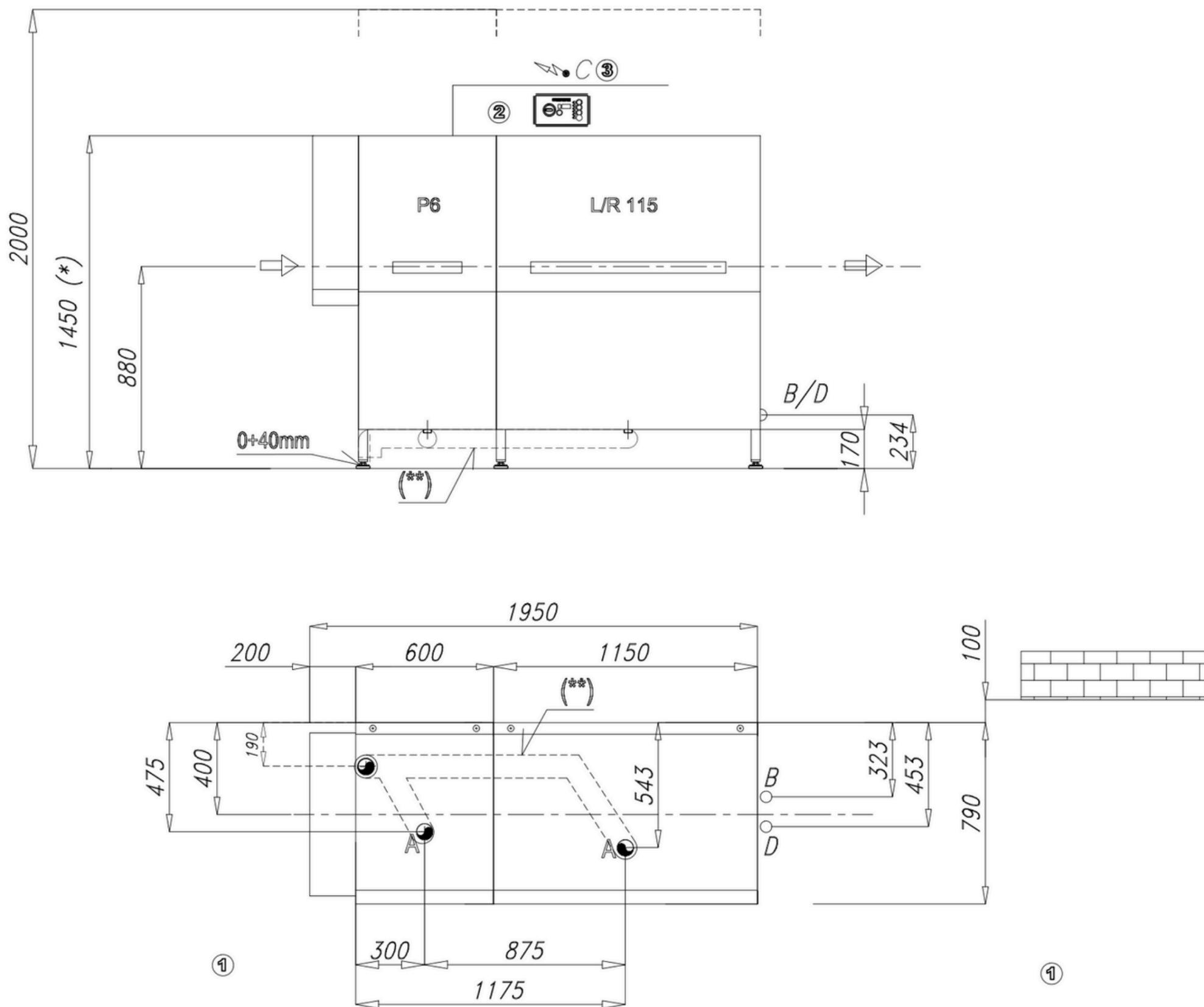
Le schéma ci-dessus représente la machine standard sans l'ajout d'accessoire ou d'option en configuration droite gauche.
