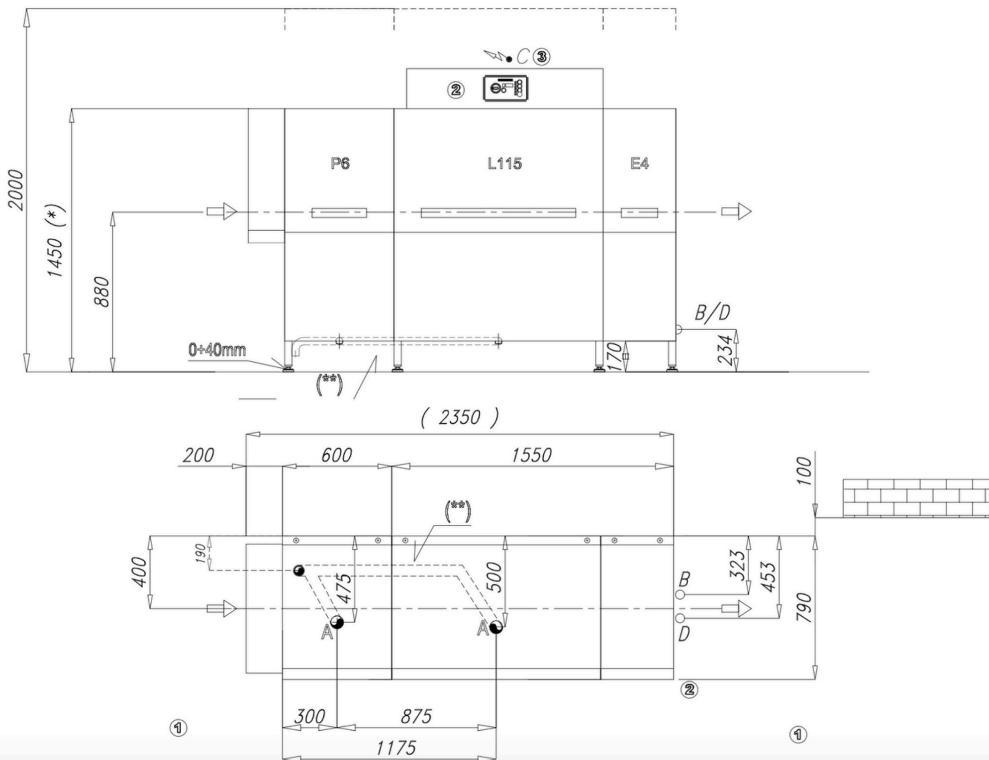
Le schéma ci-dessus représente la machine standard sans l'ajout d'accessoire ou d'option en configuration droite gauche.
